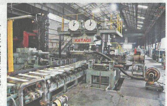
次に熱間圧延の前段階としてスラブを柔らかく、かつ内部組織を均一化するため、スラブ加熱炉で530度のスラブを7ミリにしていく。その後タンデム圧延機で板厚3ミリコイルに仕上げる。さらに顧客の要求する製品寸法、調質(強度)にするため、冷間圧延機、焼鍛する(藤本課長)。既に4段の改修、AC化は完了。次
